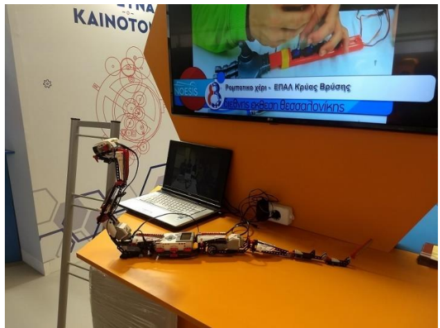
Εικόνα 3 «Ρομποτικό φίδι» με ρεαλιστική προσομοίωση κινήσεων για παρακολούθηση χώρων 1ο ΕΠΑΛ – ΕΚ Αριδαίας στο stand του ΝΟΗΣΙΣ, στο περίπτερο της Δ.Ε.Θ.
